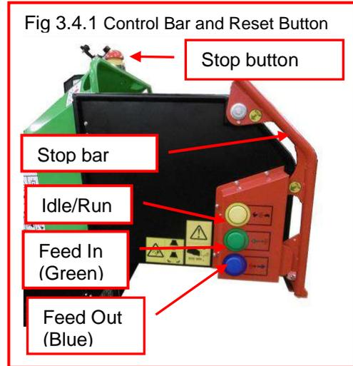
**3.4.2 Engine Stop button (fig 3.4.2a and 3.4.2b).**
